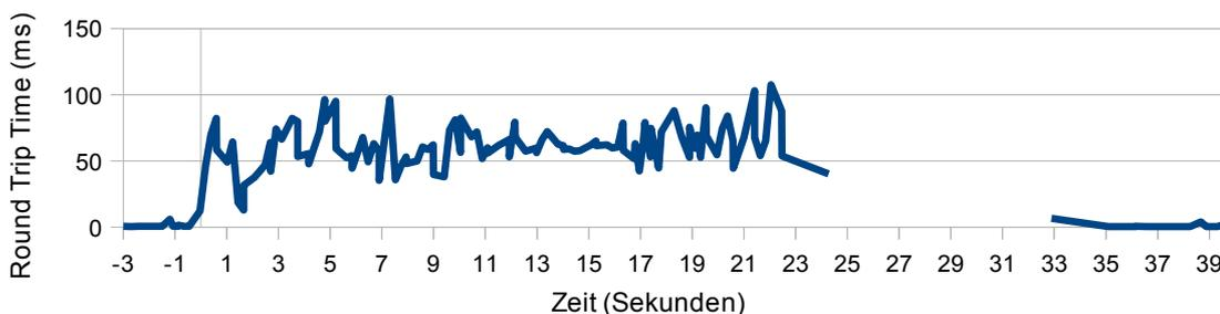
Abbildung 4.20: Pingtest mit Memtester: Ping Round Trip Time
