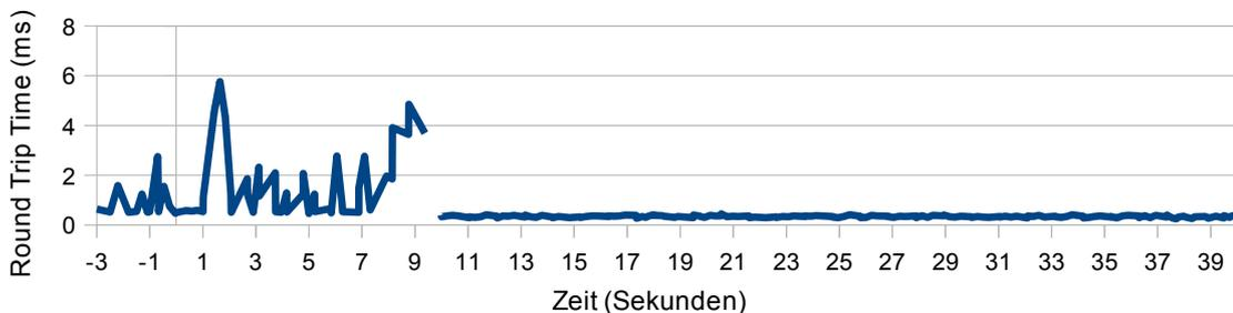
Abbildung 4.12: Pingtest ohne Last: Ping Round Trip Time
