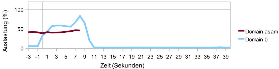
Abbildung 4.42: Streaming Test ohne Last: Prozessor Auslastung auf Kirsche (xentop)
