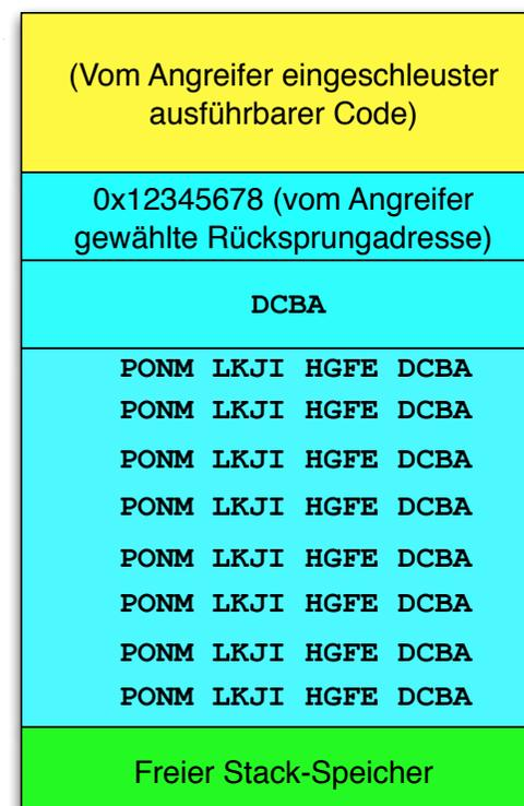
Stack bei Buffer Overflow
