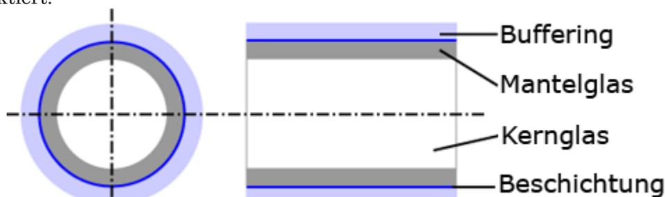
Abbildung 2.2-1 Aufbau eines Lichtwellenleiters [10]
