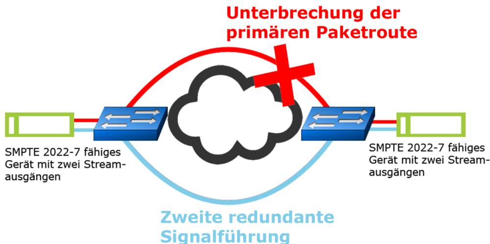
Abbildung 3.4-3 Prinzip der Zwei-Wegeführung in SMPTE 2022-7 [31]
